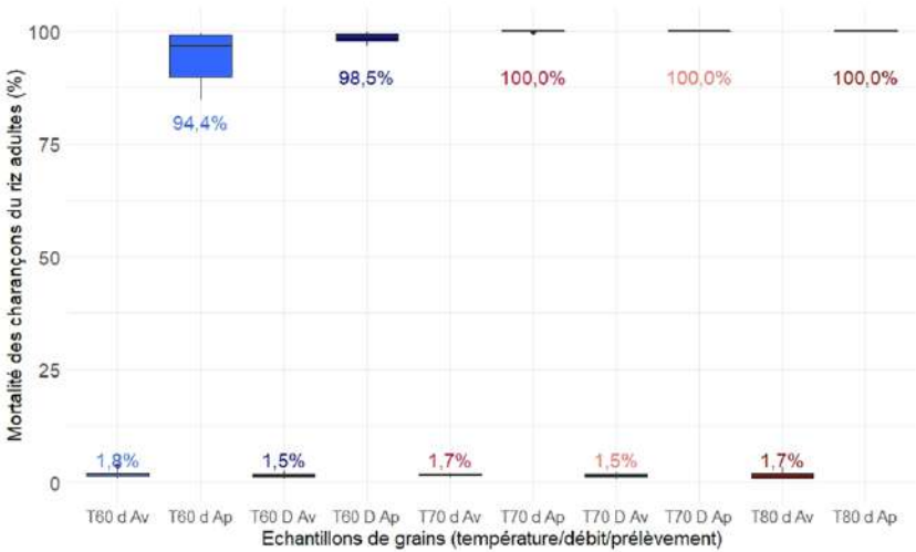
Figure 5 : Mortalités des charançons adultes dans les prélèvements de blés effectués avant ou après passage dans le microonde, pour les différentes modalités de chauffage testées (température / débit)
