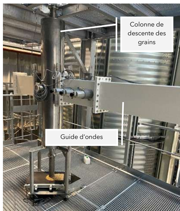
Figure 2 : Colonne d'application microonde de SAIREM intégrée à la tour d'essai d'ARVALIS
