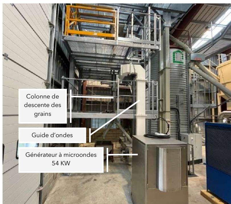
Figure 1 : Tour modulaire pour le test d'équipements temporaires sur la plateforme d'ARVALIS
