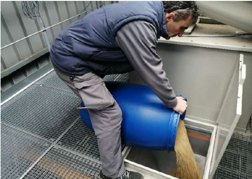
Figure 3 : Chargement du blé infesté au sommet de la tour comportant la colonne microonde
