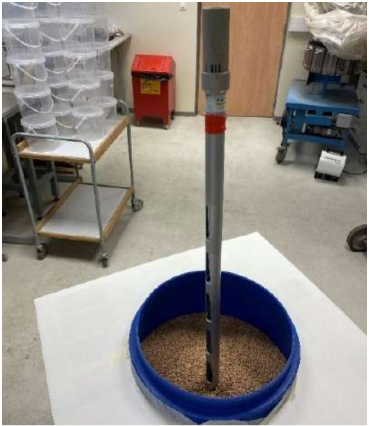
Figure 4 : Echantillonnage à la canne sonde dans un fût de blé infesté par des charançons du riz
