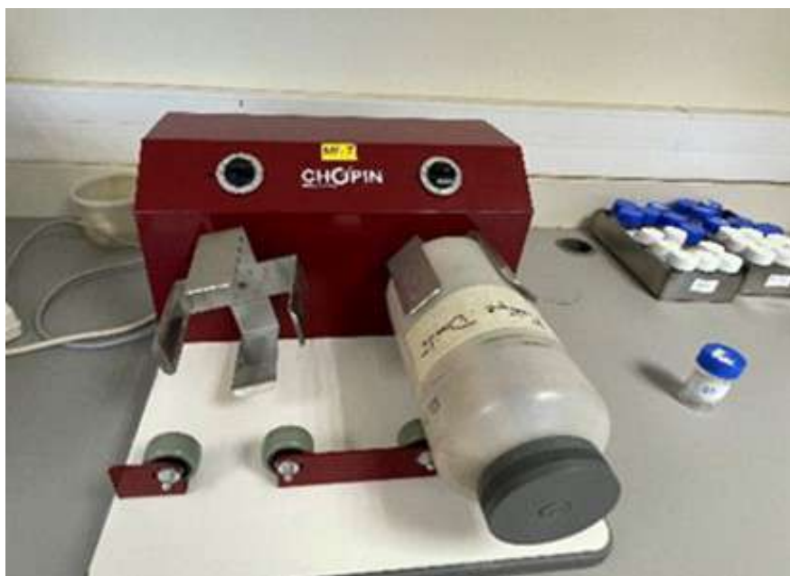
Figure 1 : Mélangeuse Chopin MR2L
