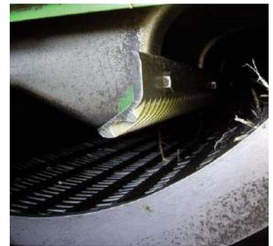
Photo ARVALIS / Moissonneuse batteuse : écart batteur - contre-batteur
