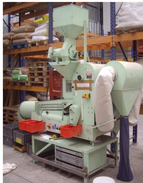
Figure 2 : Nettoyeur-séparateur Mini Petkus Rohr 200
