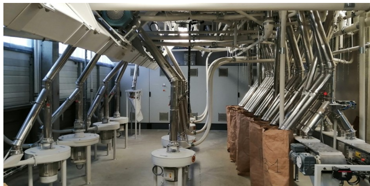
Postes d'échantillonnage des farines de passage
