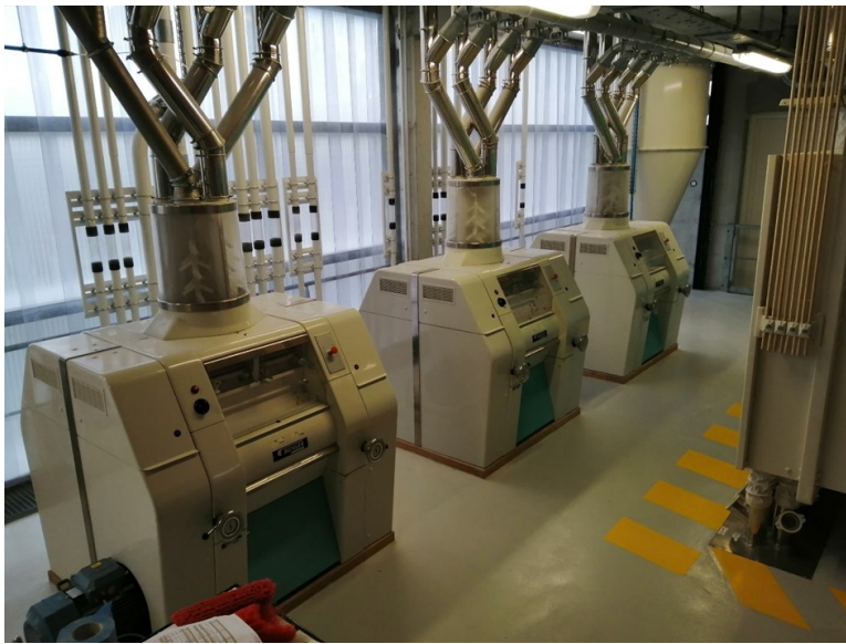
Ligne des appareils à cylindre du moulin de l'ENSMIC
