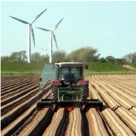
Figure 10. Brûleur thermique. L'élimination des adventices est réalisée grâce au choc thermique engendré par la flamme. Encore peu pratiqué en raison de son coût élevé, le désherbage thermique doit être réalisé sur des adventices au stade cotylédon. Il permet d'intervenir sur une plantation avec un buttage définitif et est moins dépendant des conditions climatiques que les outils mécaniques. Il ne relance pas de nouvelles germinations. Les carburants utilisés sont généralement des gaz (butane ou propane) mais de nouvelles sources apparaissent aujourd'hui, certains agriculteurs utilisent par exemple de l'huile de colza.
