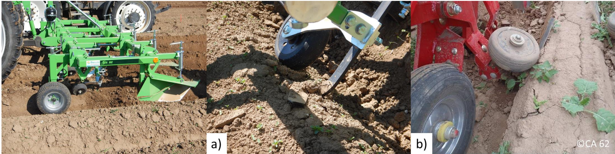
Figure 9. Sarclage des flancs de butte. Des socs à ailettes permettent d'intervenir sur des adventices développées. Disponible chez a) AVR et b) Grimme.
