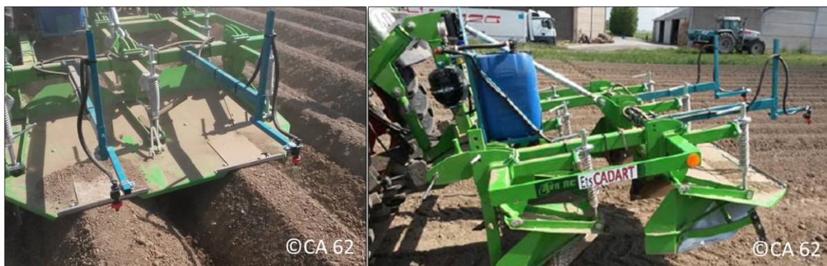
Figure 14. Dispositif de localisation de la pulvérisation placé sur le buttoir (Chambre d'agriculture du Nord- Pas de Calais, 2016).
