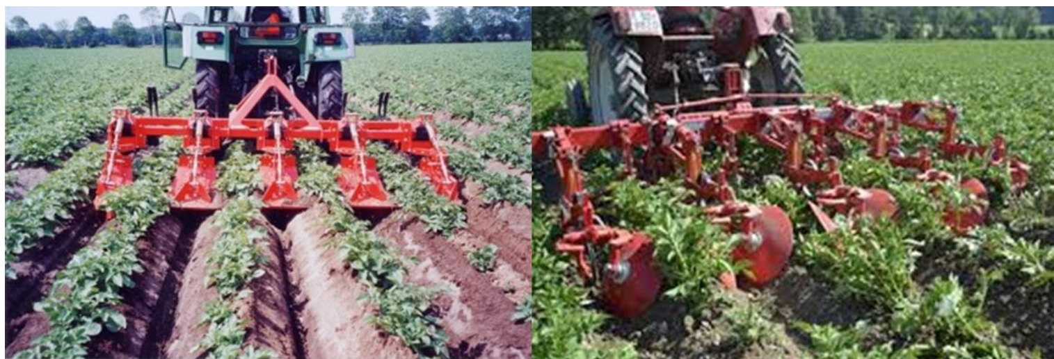
Figure 6. Buttoirs traditionnels. Il faut veiller à ne pas endommager le système racinaire de la pomme de terre en retirant les 2 extérieures travaillant le fond de l'inter-rang lors des passages à un stade avancé de la pomme de terre.
