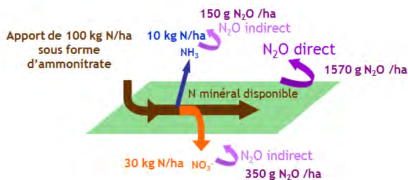
Figure 1 : Résultats d'estimation des émissions au champ de \text{N}_2\text{O} induites par l'apport de 100 kg/ha d'ammonitrate, selon la méthode GIEC tier 1, 2006 (utilisation des taux d'émissions proposées par GIEC tier 1, 2006 par défaut pour estimer les pertes de \text{NH}_3 et de \text{NO}_3^- )
