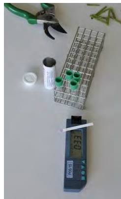
Photo 2. Matériel pour la mesure JUBIL® basée sur le dosage de la teneur en nitrate du jus de base de tige pour estimer le niveau d'alimentation de la plante (INRA, Arvalis- Institut du végétal).
