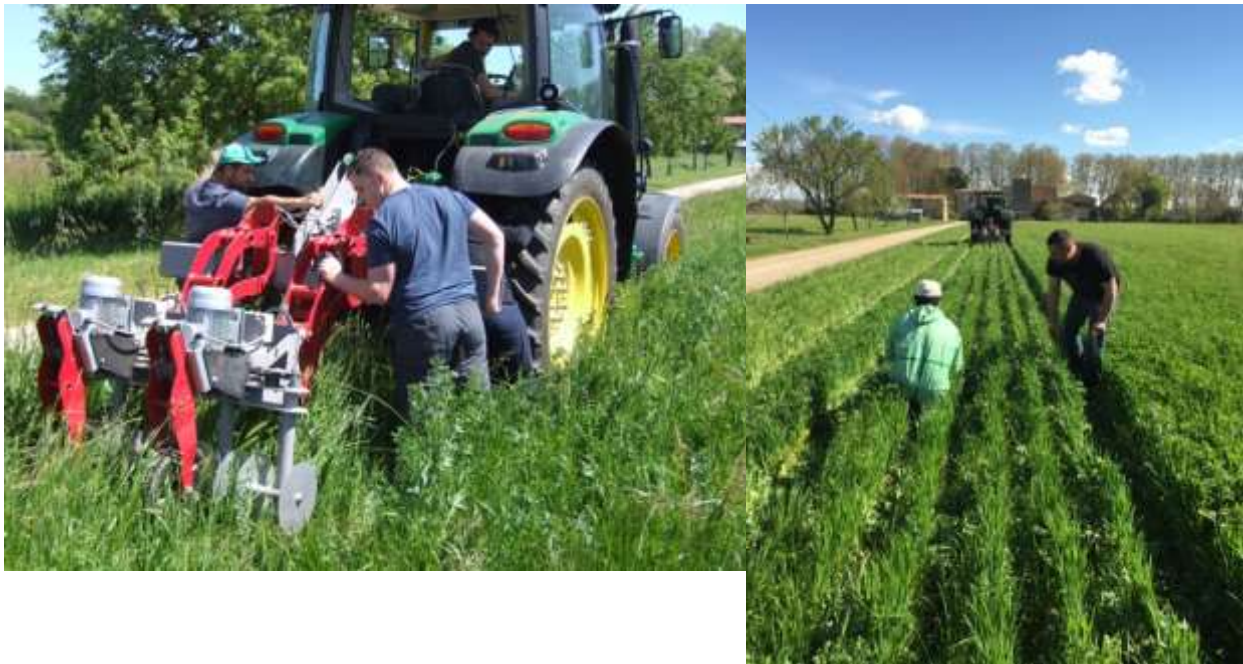
Version 2 du prototype du broyeur interligne à l'essai monté sur la poutre Gaïa d'Eco-Mulch.
