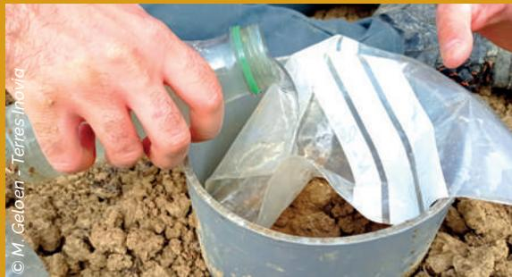
Le test beerkan est simple. Il est à réaliser dans une zone de sol homogène et en condition de sol frais (ressuyé), doit être répété pour bien prendre en compte les différences de tassements (six répétitions sont conseillées). Si les gammes d'infiltrations souhaitables par grandes classes de textures restent encore à approfondir, une mauvaise infiltration de l'eau (durée supérieure à 30 minutes pour 10 mm d'eau au cours du test) signale un problème de tassement.
