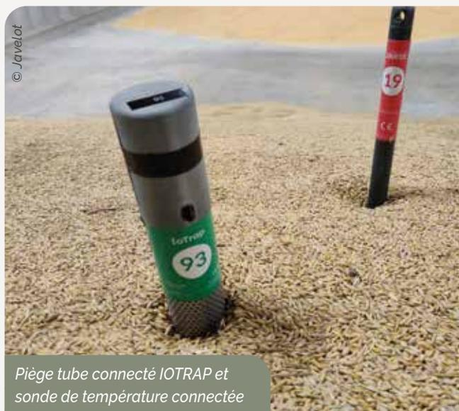
Piège tube connecté IOTRAP et sonde de température connectée
