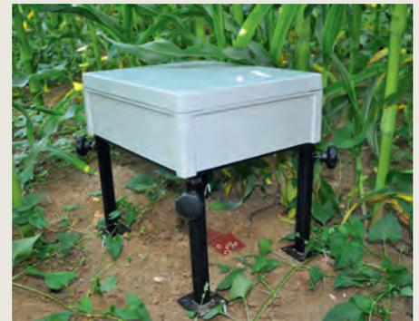
L'étude de la biodiversité fonctionnelle nécessite des méthodologies spécifiques. Ici Piscopie : une caméra couplée à une lampe infra-rouge pour les prises de vue de nuit permettant le suivi en direct des prédatations.
